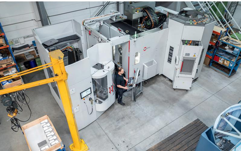
4 Die C 32 U bietet durch das adaptierte Handlingsystem HS flex die perfekte Automation für Werkstücke bis 450 Kilogramm, die sich fertig gerüstet bevorraten lassen © Hermle
