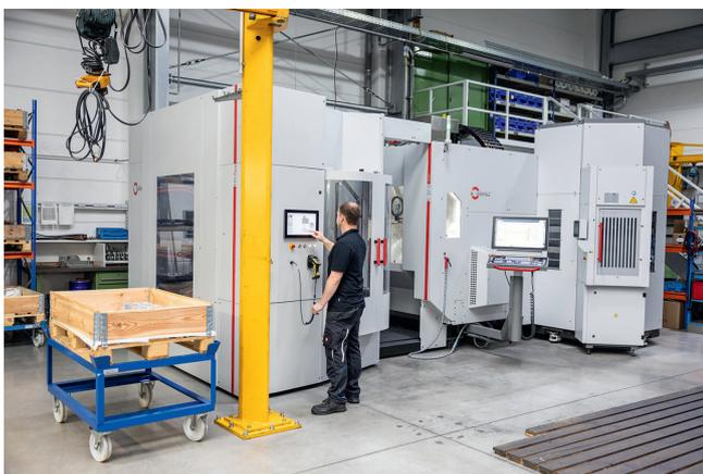
2 Die Hermle C 32 U HS flex fertigt simultan mit fünf NC-Achsen Werkstücke mit einem Gewicht von bis zu 1000 kg © Hermle
